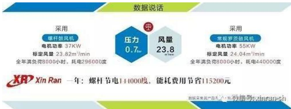
**节能环保:** 以一台 37KW 的螺杆鼓风机与常规罗茨鼓风机比较, 用事实数据说话: 螺杆鼓风机电机功率 37KW, 标定风量 23.82 立方每分钟, 全年满负荷 8000 小时, 耗电 296000 度。而普通罗茨鼓风机电机功率 55KW, 标定风量 24.04 立方每分钟, 全年满负荷 8000 小时, 耗电 440000 度, 一年节电 144000 度, 能耗费用节省 115200 元。
