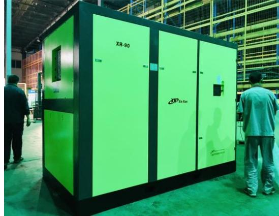
信然螺杆无油鼓风机：排气量 239~8605m<sup>3</sup>/hr，排气压力 0.3~1.2Bar，节能 35%以上...
